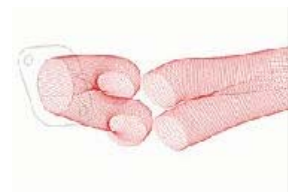
Flächenrückführung eines gescannten Ansaugkanals
