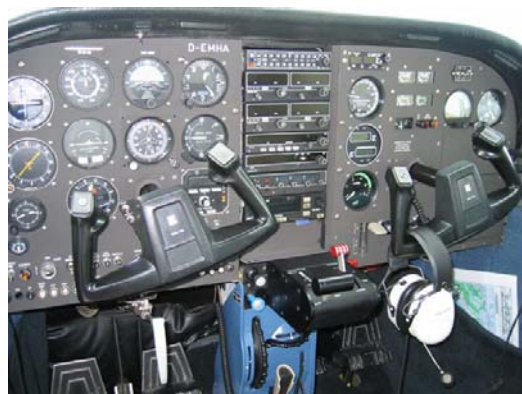
Das Cockpit der D-EMHA mit der für den SMA Motor typischen Einhebelbedienung
